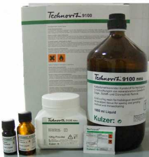
Fig. 28. Sistemul de înglobare Technovit 9100 New
